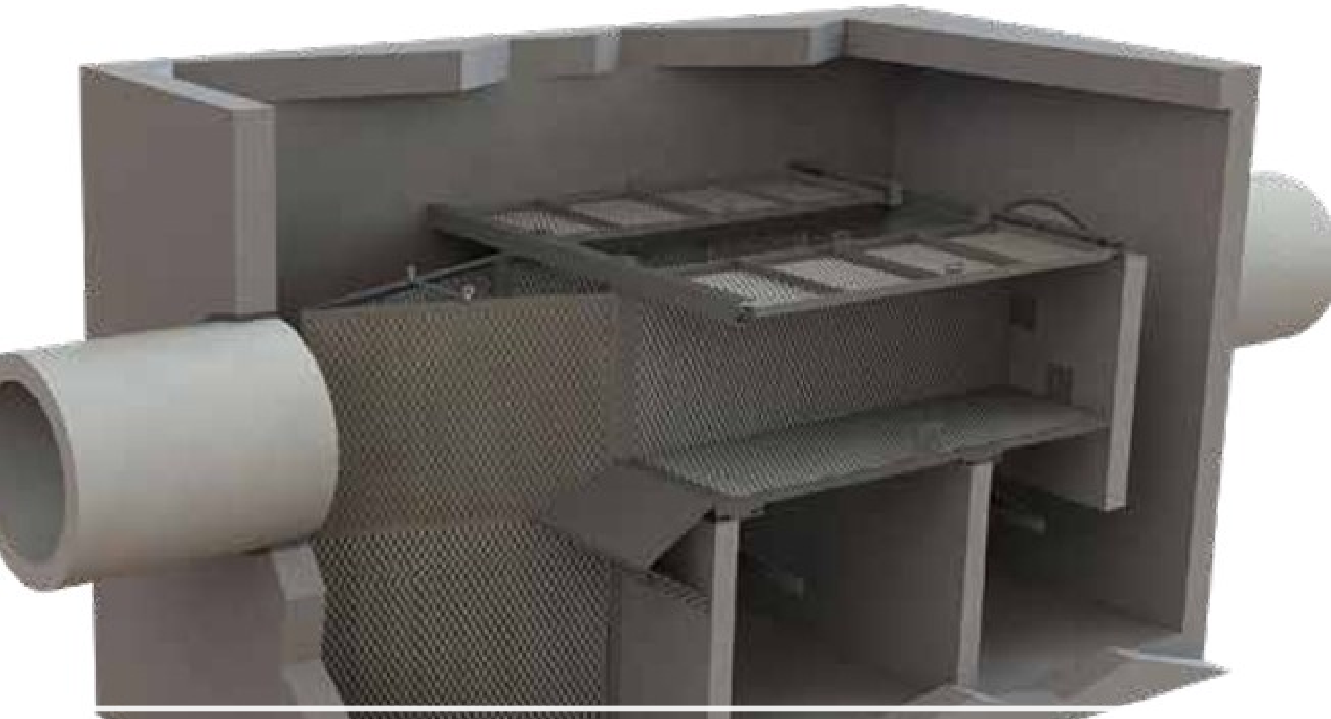
Debris Separating Baffle Box (DSBB)
